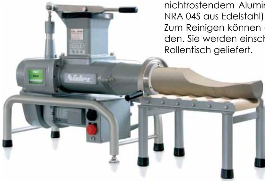
Die Tonschneider sind eine wichtige Hilfe bei der Aufbereitung der Massen. Sie homogenisieren und verfestigen die vorgemischten Massen zu einem Strang, können jedoch der Masse kein überschüssiges Wasser entziehen.
