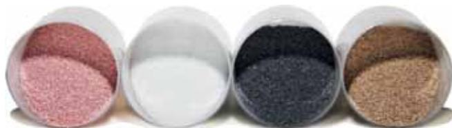
**Glasurgranulate** werden Glasuren zugemischt, um Sprekeffekte zu erzielen (wie zum Beispiel bei unserer Glasur A 983 Confetti auf Seite 19). Nach der Zugabe der Granulate darf die Glasur nicht mehr abgesiebt werden. Brennbar bis 1250°C. Zugabemenge: 0,2 - 9 %.
