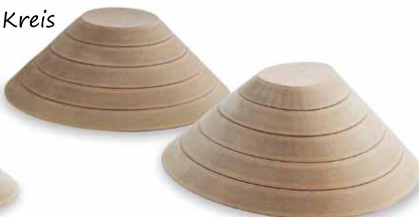
Diese Überformen werden aus 18 mm starkem feuchtigkeitsresistenten **MDF** gefertigt. Die Kanten der Formen sind in einem 45° Winkel abgeschrägt, somit sind die Formen **stapelbar** und können einfach für das Herstellen von unterschiedlichen Größen gestapelt werden.
